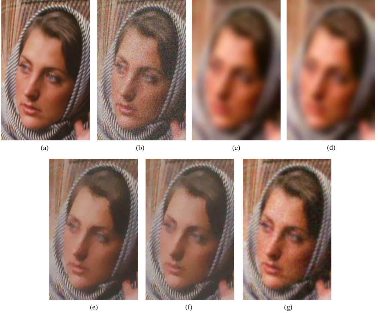
Şekil 3. Klasik yaklaşımlarla gürültü azaltma: a) Özgün imge, b) Yapay olarak standart sapması \sigma = 20 olan Gauss gürültüsü eklenmiş imge, c) Sadece düzenleştirme terimi içeren ısı denklemiyle elde edilen sonuç [4], d) Alçak geçiren süzgeçle elde edilen sonuç, e) Sadece düzenleştirme terimi içeren Perona-Malik yaklaşımıyla elde edilen sonuç [5] ve f) Hem düzenleştirme terimi hem de uygunluk terimi içeren Perona-Malik yaklaşımıyla elde edilen sonuç ve g) Hem düzenleştirme terimi hem de uygunluk terimi içeren ısı denklemiyle elde edilen sonuç
