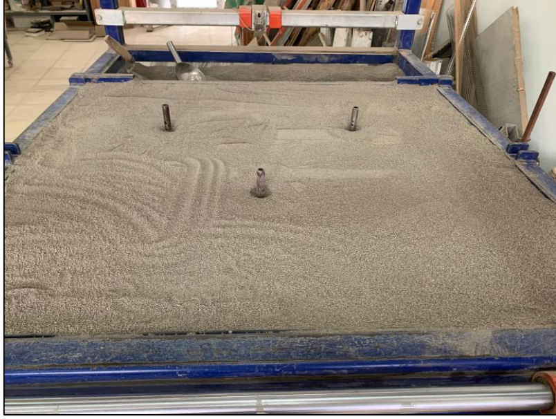
Şekil 5. Kazıklar Çakıldıktan Sonraki Görünüm
