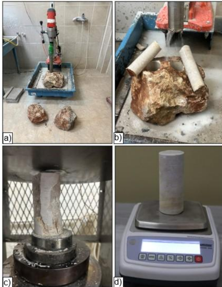
Şekil 6: Taş ocağından elde edilen malzemeye yönelik gerçekleştirilen deneysel çalışmalar: a) karot örneklerinin alınması, b) standartlara uygun silindirik numunelerin hazırlanması, c) tek eksenli basınç dayanımı (UCS) deneyi, d) birim hacim ağırlık tayini
