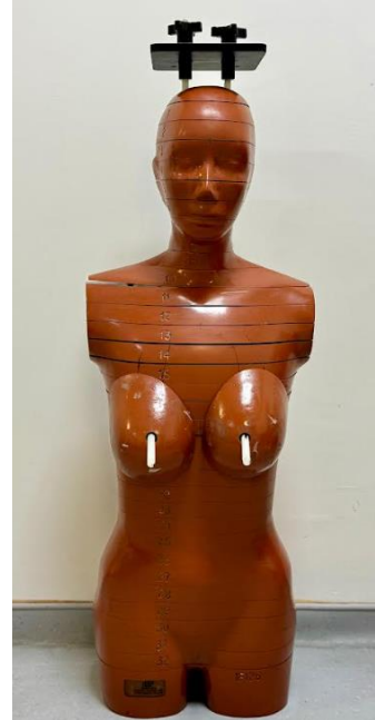
Şekil 1. Alderson Rando fantom baştan pelvise kadar uzanan insan vücudu anatomisini temsil eden kesitli bir yapıya sahiptir
