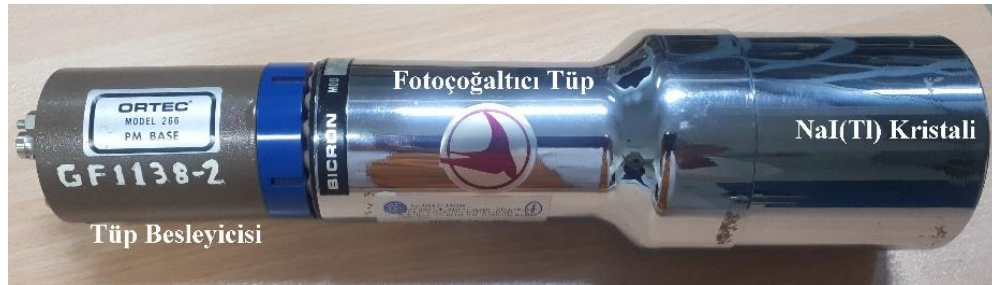
Şekil 2: Karşılaştırma amacıyla kullanılan NaI(Tl) sintilasyon dedektörünün fotoğrafı.
