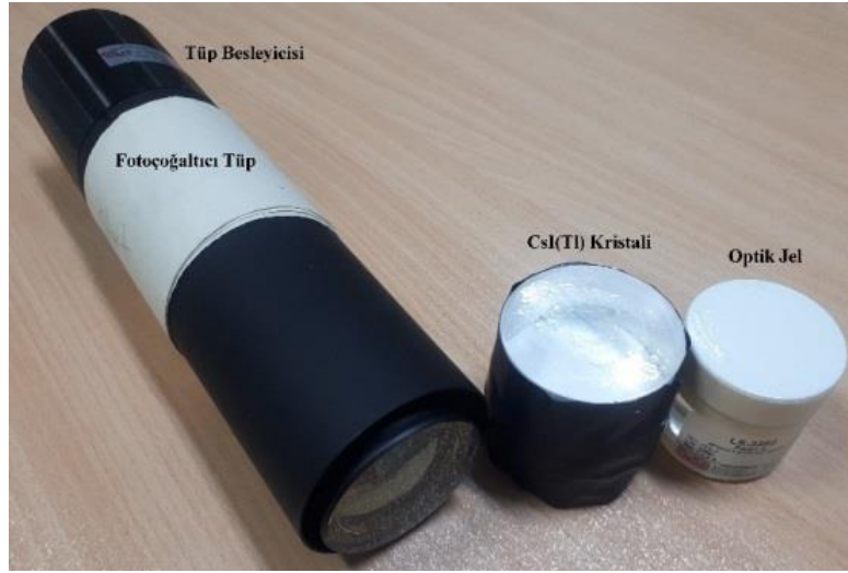
Şekil 1: CsI(Tl) sintilasyon dedektörünü meydana getiren fotoçoğaltıcı tüp, kristal ve optik jel malzemelerinin görünümü.
