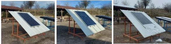
Şekil 2. Güneşli, gölgeli ve karlı hava koşullarında çalışan 40° eğim açılı PV panel
