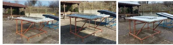
Şekil 6. Güneşli, gölgeli ve karlı hava koşullarında çalışan 0° eğim açılı PV panel
