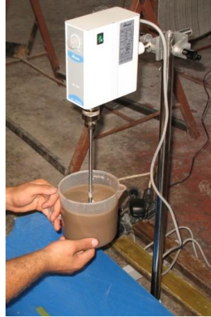
Şekil 2. Hazırlanan reçine ve seramik tozun mekanik karıştırıcı ile karıştırılması
