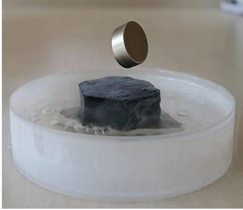
Şekil 2. Sıvı azot ile soğutulmuş süperiletkenin kalıcı mıknatısa uyguladığı manyetik kaldırma kuvveti [27, 33]
