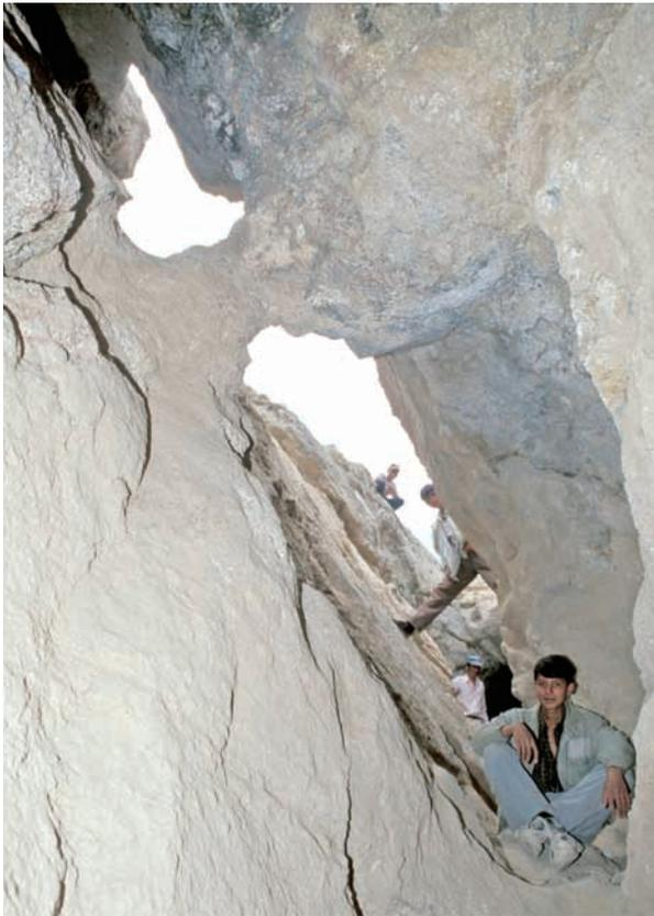
Abb. 6: Karnab, Grube 5-3. Blick aus dem Inneren nach oben, wo die stehen gelassene Bergfeste mit dünnen Gangresten (Pfeil) seit Jahrtausenden die Sicherheit garantiert.
