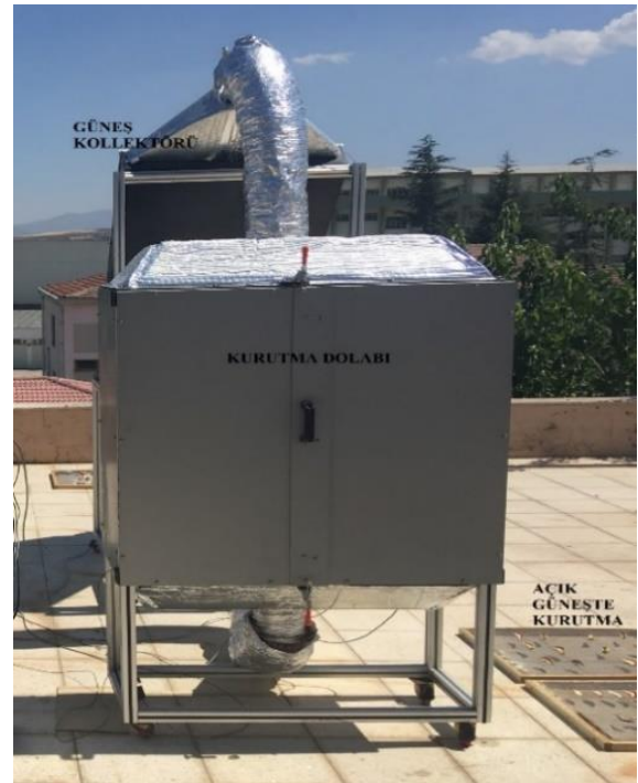
Şekil 1. Hava ısıtmalı güneş kollektörlü kurutma sistemi ve açık güneşte kurutma
