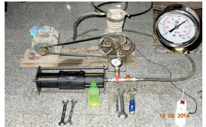
Şekil 4. Basınç test deney düzeneği (Pressure test assembly)
