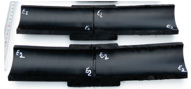
Şekil 3. Kaynaklı boruların kesit görüntüsü (The sectional view of welded pipes)
