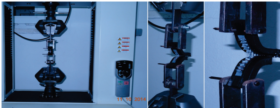
Şekil 9. Çiftli çekme-ayırma test numune tutucusu (Double peel decohesion test sample holder)
