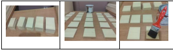
Şekil 1. Perdah işlemi yapılan deney örneklerine ve fırça ile yağların uygulanması (Yazarlar tarafından oluşturulmuştur).
