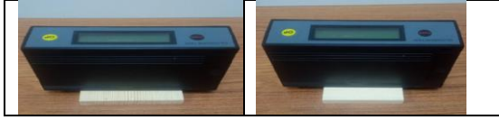
Şekil 3. Parlaklık ölçüm sistemi (Ayata, 2014) ve liflere dik ( \perp ) ve paralel ( \parallel ) açı ile parlaklık ölçümü (Yazarlar tarafından oluşturulmuştur).
