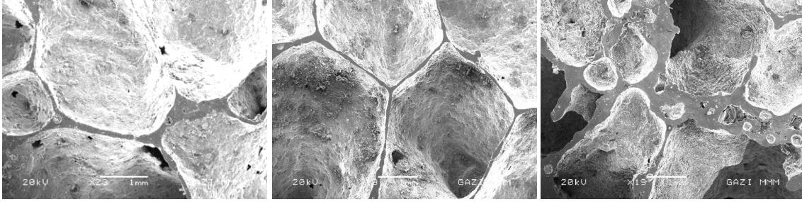
Resim 10. Soldan sağa doğru sırasıyla %0, %2 ve %4 \text{Si}_3\text{N}_4 takviyeli numunelerin SEM görüntüleri. (SEM images of the samples containing 0%, 2%, and 4% \text{Si}_3\text{N}_4 reinforcement, respectively, from left to right.)
