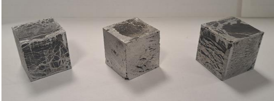
Resim 2. Deney sonucunda üretilen ve herhangi bir işleme tabi tutulmayan kübik metal köpük numunelerin görünümü. (The appearance of the cubic metal foam samples produced in the experiment without any post-processing.)
