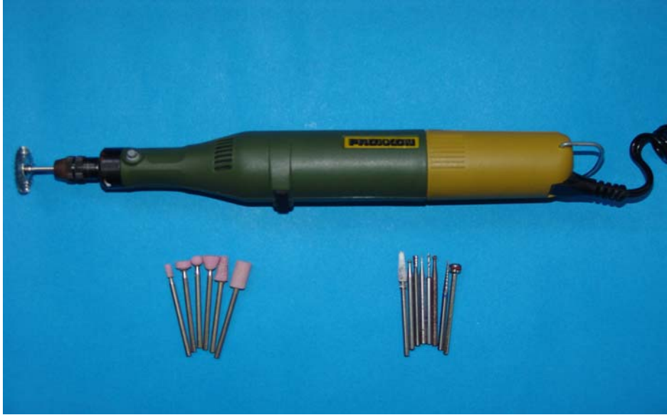
Şekil 3. Mekanik temizlemede kullanılan el matkabı ve değişik uçlar.
