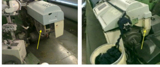
Şekil 6: Koruyucusu bulunan ve bulunmayan dokuma makinesi rapiyer kasnağı [5]
