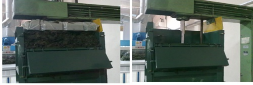
Şekil 7: Kapak açıkken çalışan bir pres makinesi [5]
