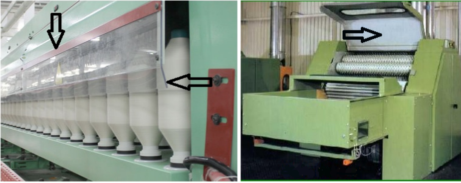
Şekil 3: Makine koruyuculu fitil makinesi ve dişli sistemleri koruma kapağı ile kapatılmış hallaç makinesi [6 ve 7]
