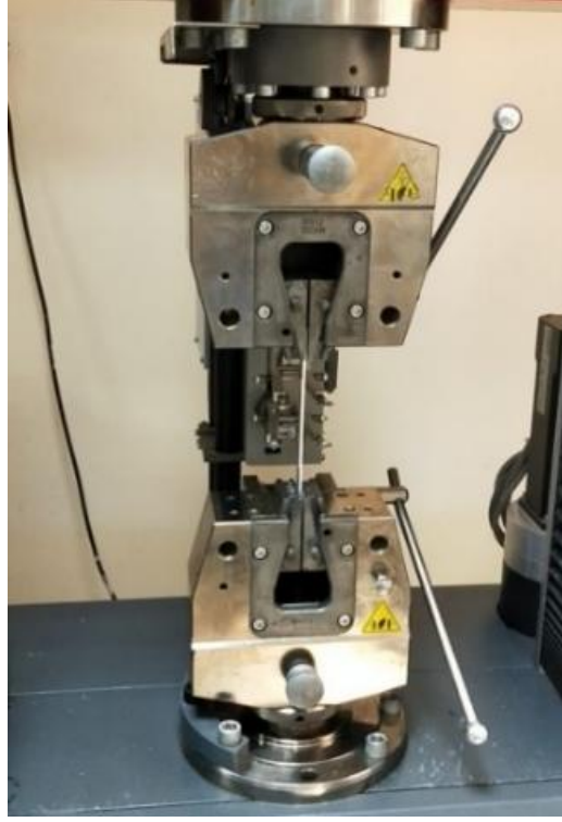
Şekil 3. Çekme Numunesinin Test Cihazında (Zwick/Roell Z100) Test Görüntüsü
