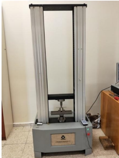
Şekil 4. Eğme Numunesinin Test Cihazında (SIOMM Üniversal Test Cihazı) Test Görüntüsü
