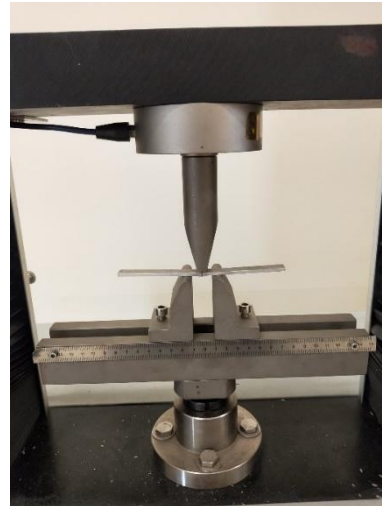
Şekil 4. Eğme Numunesinin Test Cihazında (SIOMM Üniversal Test Cihazı) Test Görüntüsü
