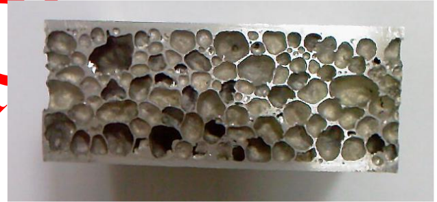
Figure 16. Sectional view of Al sandwich foam. While it is seen that the material with a higher melting point than the melting point of the foam material on both surfaces of the structure is perfectly bonded to the foam by diffusion during production, the main foam structure is present in the inner parts [1]. (Al sandviç köpüğün kesit görünümü. Yapının her iki yüzeyindeki köpük malzemesinin erime noktasından daha yüksek erime noktasına sahip malzemenin, üretim sırasında difüzyon yoluyla köpüğe mükemmel bir şekilde bağlandığı görülse de, esas köpük yapısı iç kısımlarda mevcuttur.)
