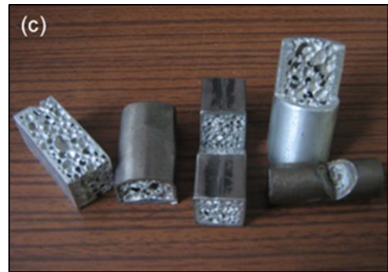
Figure 26. Al-based foam materials produced at Gazi University in various profile and pipe materials and their cross-sectional views [1]. (Gazi Üniversitesi'nde çeşitli profil ve boru malzemelerden üretilen Al esaslı köpük malzemeler ve kesit görüntüleri.)
