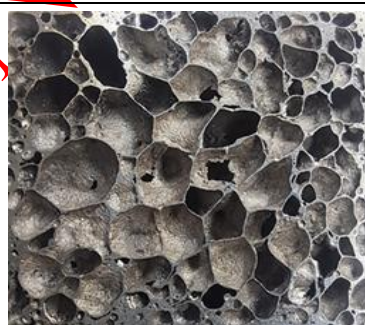
Figure 2. Pore structure of Al foam material with closed pore structure. (Kapalı gözenek yapısına sahip Al köpük malzemesinin gözenek yapısı.)
