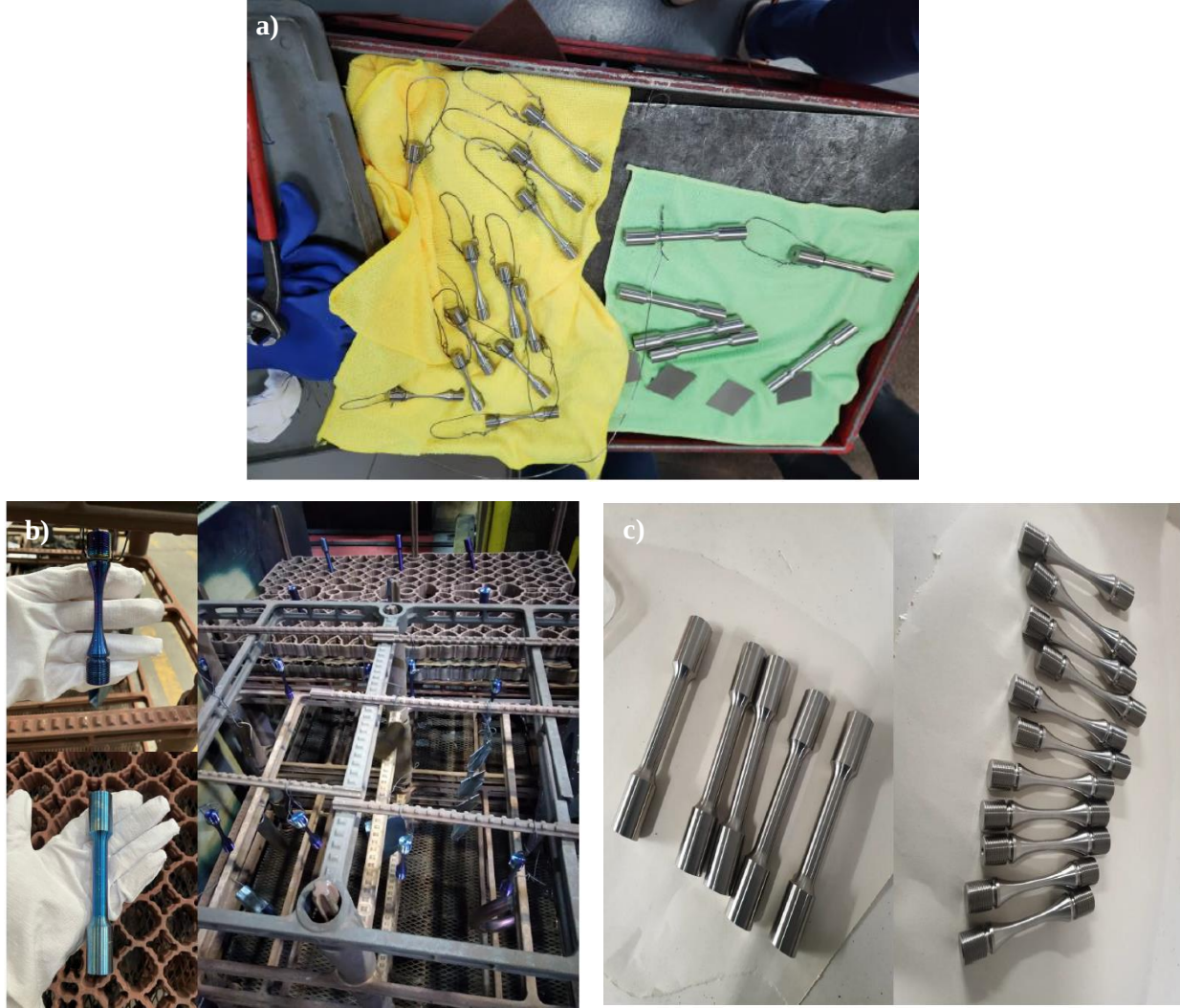
Figure 2. a) Samples before heat treatment, b) Atmosphere-controlled heat-treated samples b) Vacuum heat-treated samples (a) Isıl işlem öncesi numuneler, b) Atmosfer kontrollü ortamda ısıtılmış numuneler, b) Vakum ortamında ısıtılmış numuneler)
