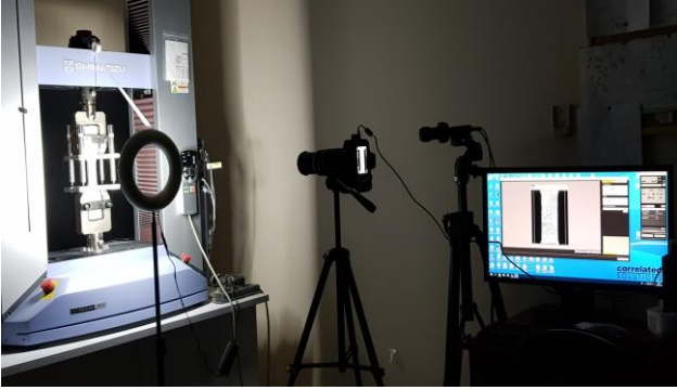
Şekil 3. Cihaz önüne konumlandırılmış DIC sistemi
