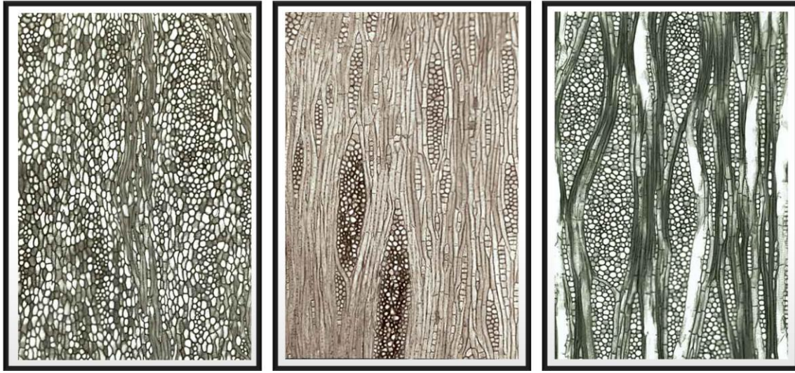
Şekil 1. Doğu Kayını’na ait 400x optik mikroskop görüntüsü (teğet kesit): Diffüz-porous damar yapısı ve çok sıralı ışınların genel dağılımı görülmektedir. (Optical microscope image of Oriental Beech at 400x magnification (tangential section): The diffuse-porous vessel structure and the general distribution of multiseriate rays can be observed)
