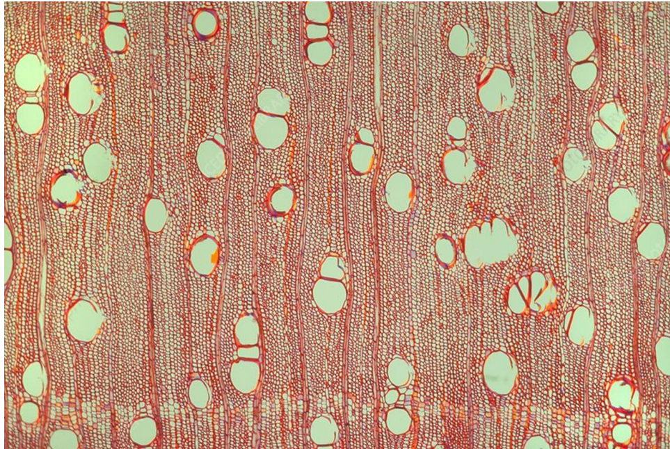
Şekil 4. Afrika Maunu'na ait optik mikroskop görüntüsü (400x, enine kesit): Damarlar düzgün konturda, yoğunluğu eş dağılımlı, parankima şeritleri belirgin. (Optical microscope image of Khaya ivorensis (400x, cross section): Vessels have regular contours, evenly distributed density, and distinct parenchyma bands.)
