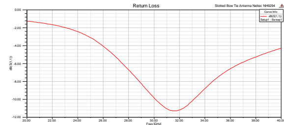
Figure 13. S_{11} result using Neltec substrate (Neltec taban malzemesi için S_{11} sonucu)
