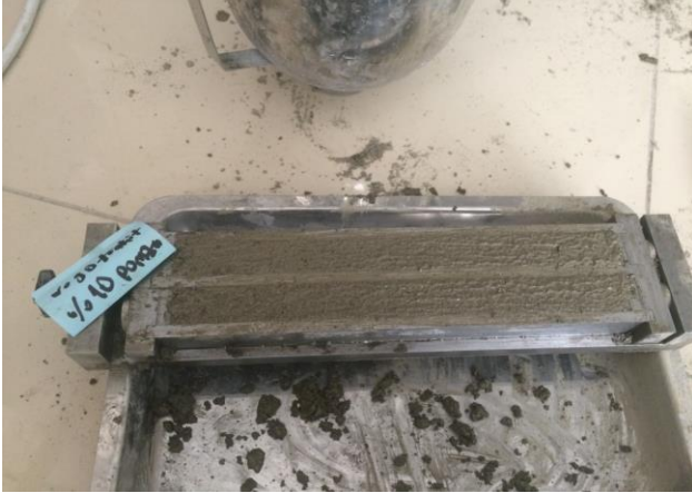
Şekil 2. Üretilen harç çubuğu numunesi
