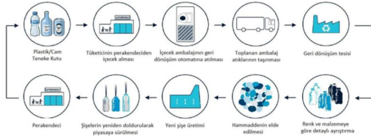
Şekil 2: Geri Dönüşüm Otomatlarıyla Tasarlanan Depozito Sistemi
