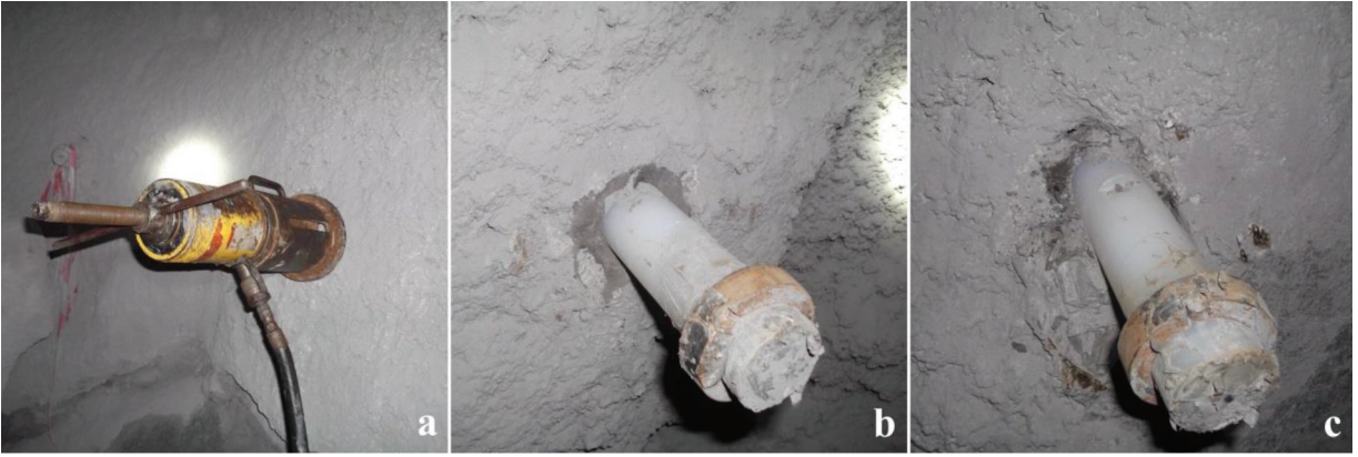
Şekil 16. Yeraltında saplama çekme testi: a) saplama çekme krikosu, b ve c) test edilmiş bazı saptamalar. Figure 16. Pull test performed in the mine: a) bolt pulling jack, b and c) some tested polyamide bolts.
