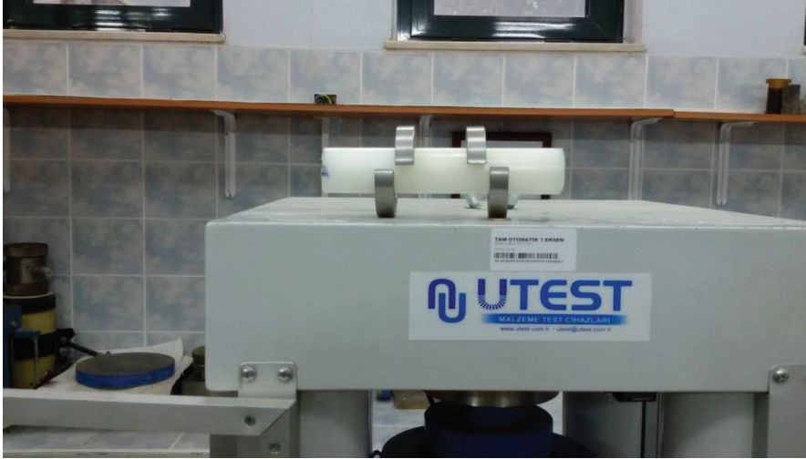
Şekil 5. Makaslama halkalarının Poliamid rod ile kullanımları. Figure 5. Shearing rings use with polyamide rod.
