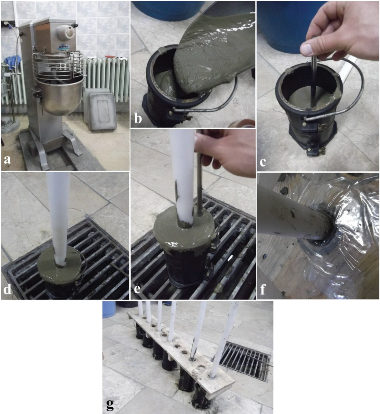
Şekil 11. Poliamid çekme/çıkarma numunelerinin hazırlanması: a) çimento/su karışımının hazırlandığı mikser, b) çimento enjeksiyonunun kalıplara dökülmesi, c) şişleme, d ve e) enjeksiyon içine yerleştirilmiş poliamid saplama, f) delikli saplama tutma sehpası ve saplamaların oynamaması için bantlanmış delik, g) saplama tutma sehpası ve enjeksiyon içerisindeki poliamid saplamalar.
