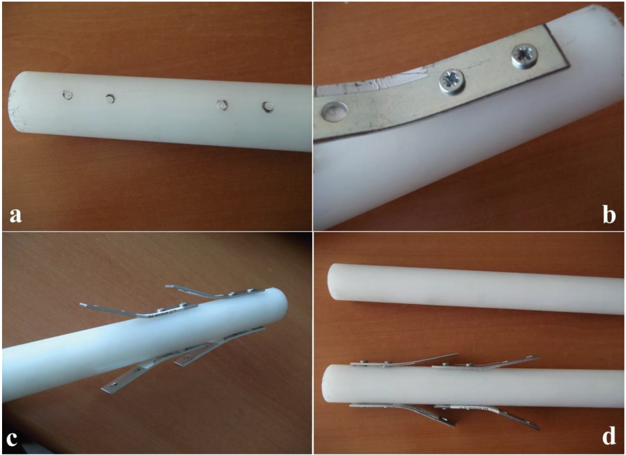
Şekil 12. Poliamid saplama ucundaki kanca: a) ucu delinmiş poliamid saplama, b ve c) vidalanmış kanca, d) kancalı ve kancasız poliamid saplamalar.
