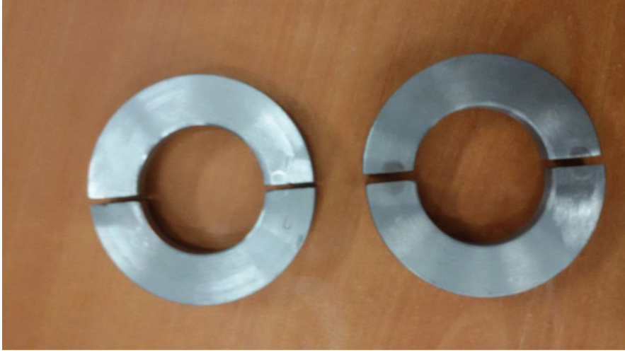
Şekil 4. Makaslama testlerinde kullanılan ayrılmış çelik halkalar. Figure 4. Semi circular rings used in shear strength test.
