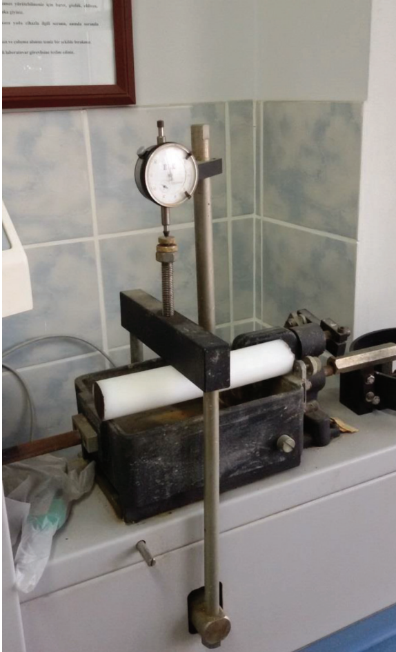
Şekil 9. Poliamid sünme testi (3 noktadan eğilme altında). Figure 9. Polyamide creep test under three point flexure.
