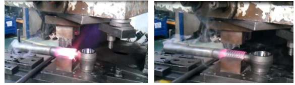
Resim 3. Sıcak Pres Birleştirme Yöntemi
