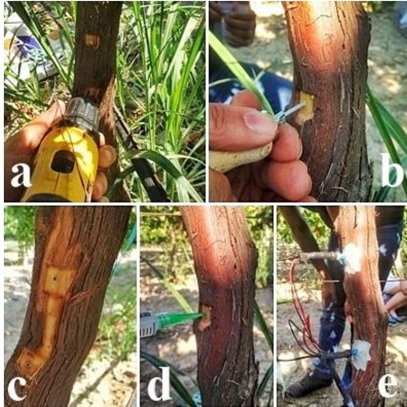
Şekil 2. Sap flow meter sisteminin asma üzerine montaj işlemi (sensörlerin yerleştirme yuvalarının açılması (a), alüminyum tüplerinin yerleştirilmesi (b), tüplerin montaj işleminin tamamlanması (c), alüminyum tüplerinin içerisine silika jelin doldurulması (d), tüm sensörlerin yerleştirme işleminin tamamlanması (e)) Figure 2. Installation of sap flow meter system on grapevine (opening of the installation holes of sensors (a), placement of aluminum tubes (b), completion of installation of tubes (c), filling aluminum tubes with silica gel (d) completion of installation of all sensors (e))
