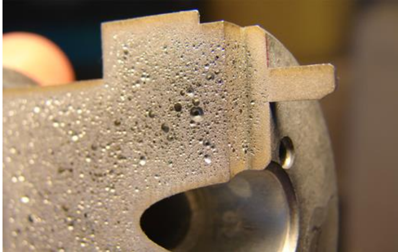
Şekil 8. Metal köpüklerin makine gövdesi olarak kullanımı
