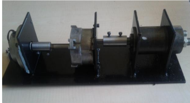
Şekil 6. Hız kesici makine düzeneği
