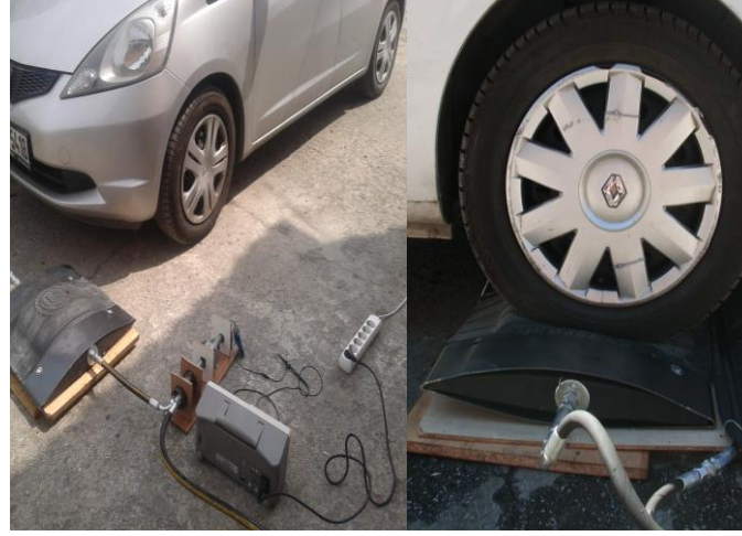
Şekil 7. Hız kesici araç geçiş testi.
