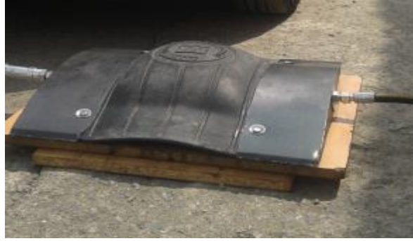
Şekil 5. Hidrolik sıvı dolu hız kesici
