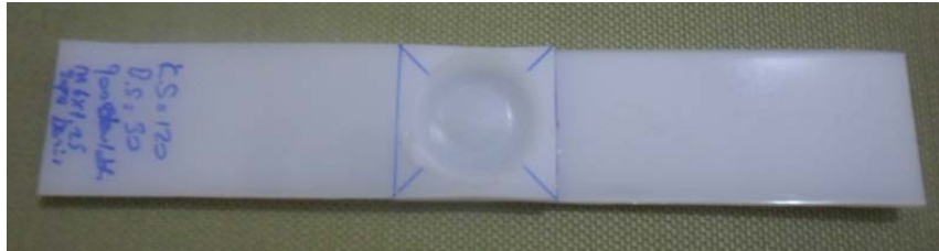
Şekil 3. SKNK yöntemi ile üretilen kaynaklı numune (Welded specimen produced by FSSW method)
