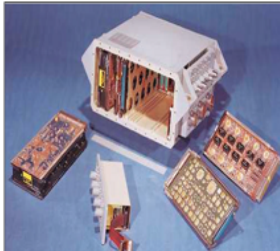
Şekil 1. Alüminyum kontrol kutusu ve takılabilir modüller
