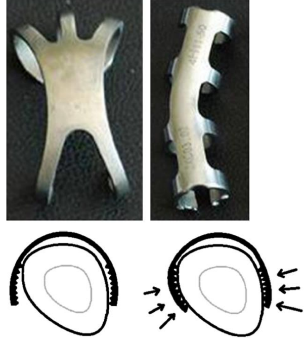
Şekil 11: Şekil hafızalı alaşımdan imal edilmiş eksternal fiksatorler [26]
