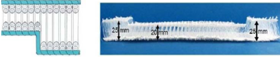
Şekil 8 Çözümlü Örme Sandviç Örme Tekstillere Örnek [6]
