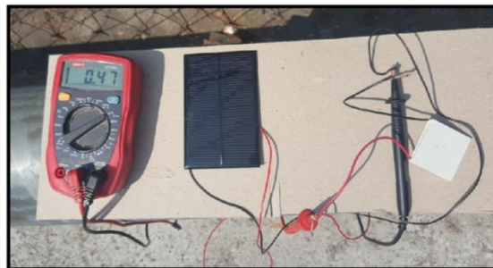
Şekil 5. Fotovoltaik Panele Peltier'in Bağlanması
