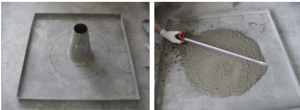
Şekil 2. Yayılma deneyi ve T50 süresi
