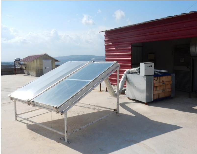
Şekil 2. Güneş enerjisi destekli kurutma sisteminin resmi
