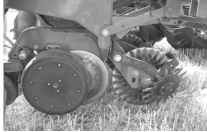
Şekil 2. Doğrudan ekim makinasının ekim ünitesi (Anonymous b, 2004)
