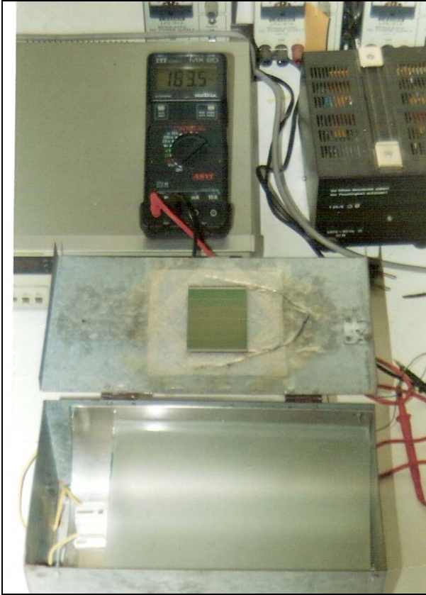
Şekil 3. Işığı dağıtacak özellikteki opal camın ışık kaynağı üzerine yerleşimi.
