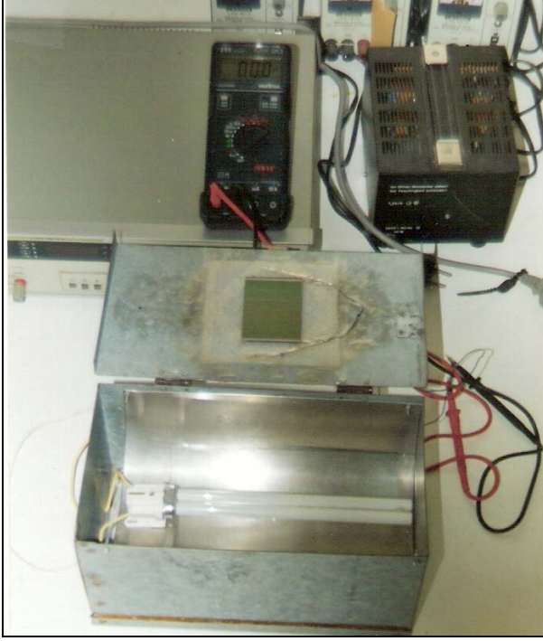
Şekil 2. Yaprak alanı ölçümünde kullanılan deneme düzeneğinde lamba, parabolik yansıtıcı ve güneş pili yerleşimi.
