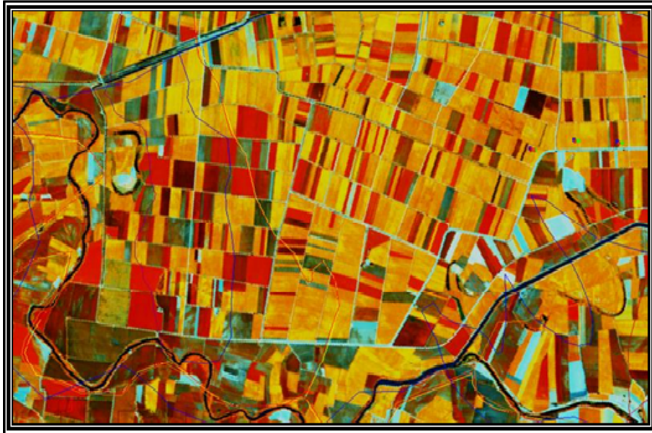
Şekil 2. YKÖ, KK, ve GK bantları ile oluşturulan kompozitte ürün deseninin görünümü (Pamuk; sarı tonları, Mısır; Kırmızı tonları, Anız veya boş toprak; mavi-yeşil renk tonları ile görülmektedir)
