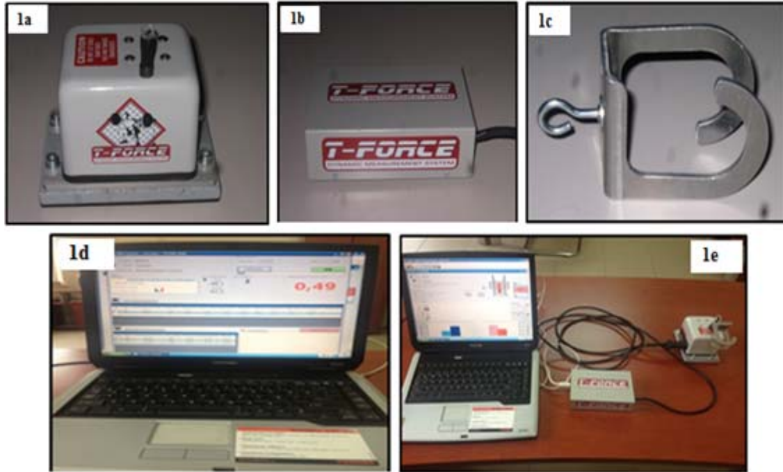
Fotograf 1. T-Force dinamik ölçüm sistemi (1a) hız sensörü (1b) bilgisayara iletileri sağlayan ara birim, (1c) ağırlık halterine bağlanan çengel, (1d) sistemin yazılım programı (1e) sistemin kurulumu
