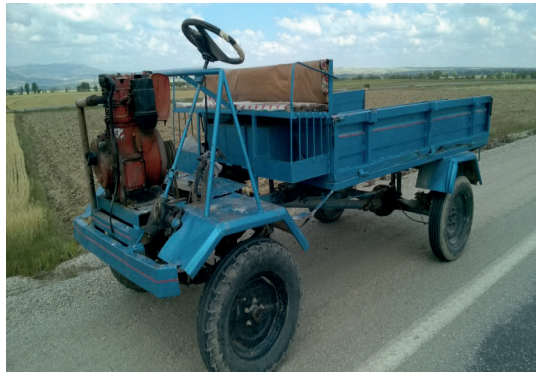
Resim 5: 1980'lerin Ortalarında Yapılan ve Hâlen Kullanılan Yüksek Şase, Demir Kasalı, Kas Gücüyle Çalışan Tek Silindirik Pancar Motorlu Patpat
