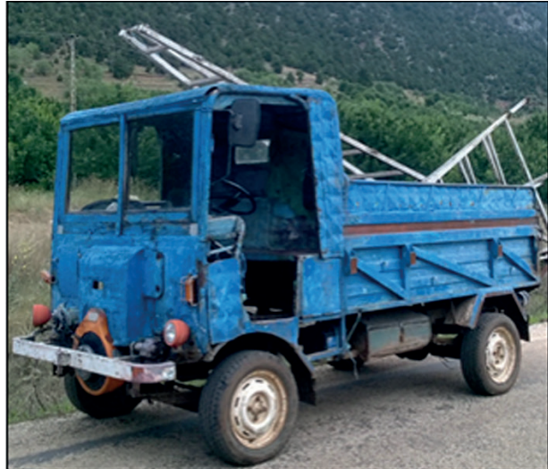
Resim. 9 Kabinli, Marşlı, Tek Silindir Lombardini Motorlu Aydınlatmalı Patpat
