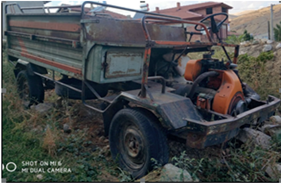
Resim 3: Patpat Osman Tarafından Yapılan Kas Gücüyle Çalışan Tek Silindirik Lombardini Motorlu Büyükkabaca Tarzı Patpat (1985)
