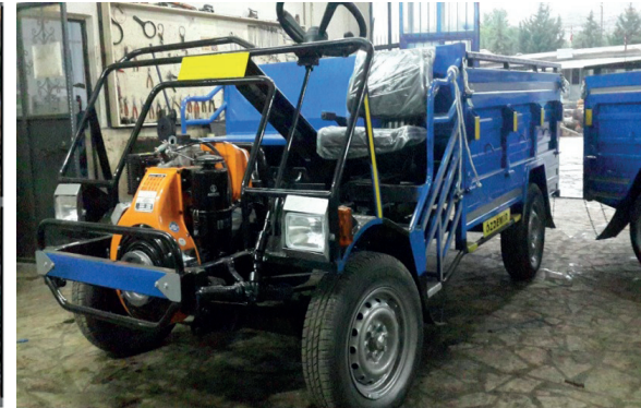
Resim 4: Marşlı, Tek Silindirik Lombardini Motorlu, Aydınlatmalı, Büyükkabaca Tarzı Patpat (2018)
