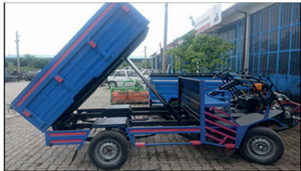
Resim.11 Damperli, Tek Silindir Lombardini Motorlu, Aydınlatmalı Patpat.
