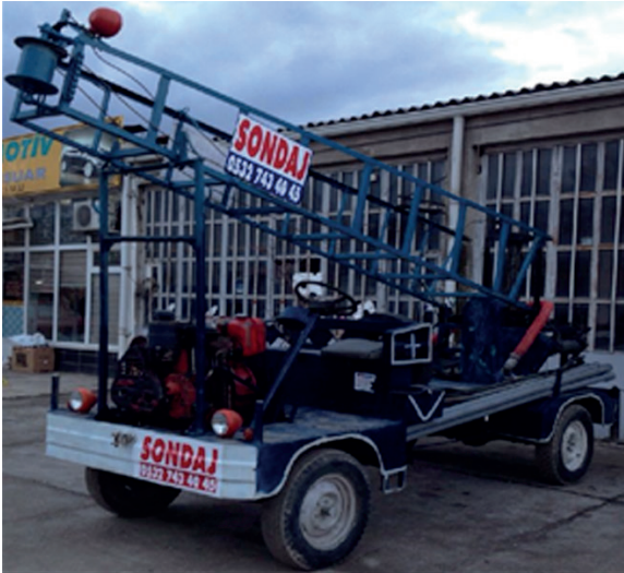
Resim. 8 Sondaj Sistemli, Marşlı, Çift Silindir Pancar Motorlu, Aydınlatmalı Patpat
