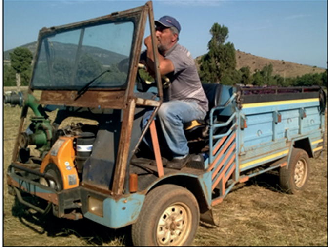
Resim.7 Sulama Sistemli, Marşlı Lombardini Motorlu Çalışan Aydınlatmalı Patpat
