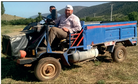
Resim.10 Murat 131 Motorlu, LPG'li, Aydınlatmalı 4*4 Patpat.
