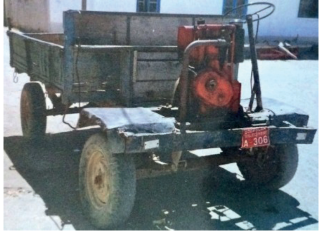
Resim 2 Yanık Osman Tarafından 1980'lerin Başında Yapılan ve Hâlen Kullanılan Ağaç Kasalı, Pancar Motorlu Patpat
