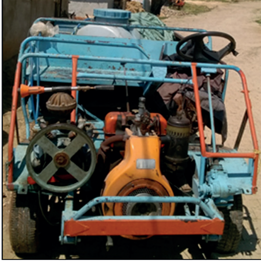
Resim.6 İlaçlama Sistemli, Kas Gücüyle Lombardini Motorlu Patpat
