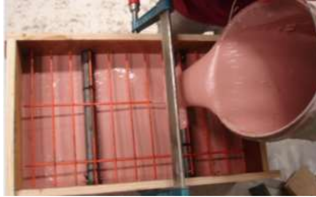
Şekil 5. Mastar üzerine alçı döküm işlemi (Plaster casting process on infinite)
