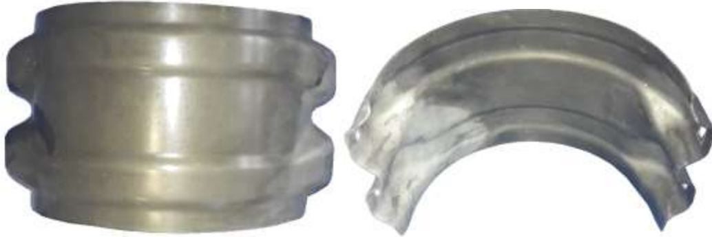
Şekil 9. Üretilmiş sac parça (Produced sheet metal part)
