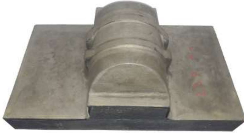
Şekil 8. Üst kalıp (Upper die)
