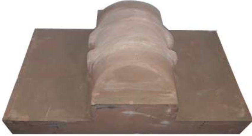
Şekil 6. Alçı kalıp (Plaster die)
