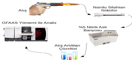
Şekil 2. Fişek sayısına bağlı olarak namlu içinde biriken atış artığındaki elementlerin konsantrasyonunu belirlemek için izlenen adımların şeması.
