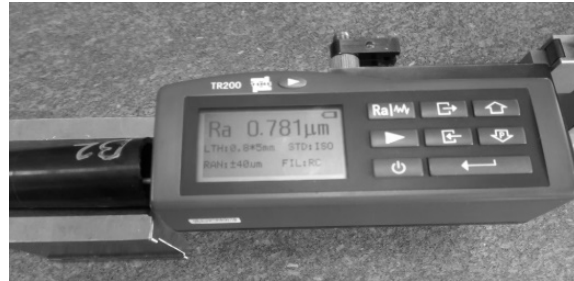
Şekil 4. Meme lastiği pürüzlülük deneyinin yüzey pürüzlülük cihazı ile yapılışı
