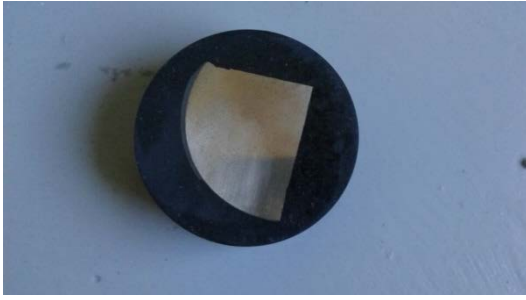
Şekil 4. Bakalite alınmış ve yüzey hazırlama işlemleri yapılmış numune
