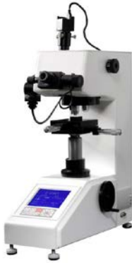
Şekil 5. Mikro-Vickers sertlik test cihazı
