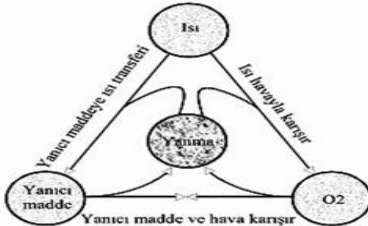
Şekil 1: Yangın Üçgeni (Tama, 2012),
