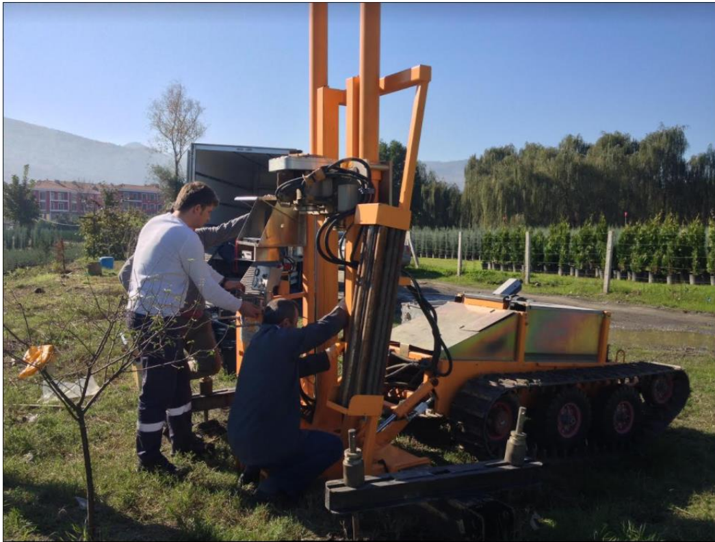
Şekil 3. CPT Deneyinin uygulanışı
