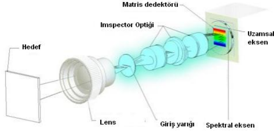
Şekil 1: Spektrometre bileşenleri.
