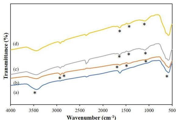
**Figure 3.** FTIR spectrum of (a)  $\text{Fe}_3\text{O}_4$  and (b)  $\text{Fe}_3\text{O}_4$ -OA nanoparticles, (c)  $\text{Fe}_3\text{O}_4$ -OA-CS and (d)  $\text{Fe}_3\text{O}_4$ -OA-GCS nanocomposites
