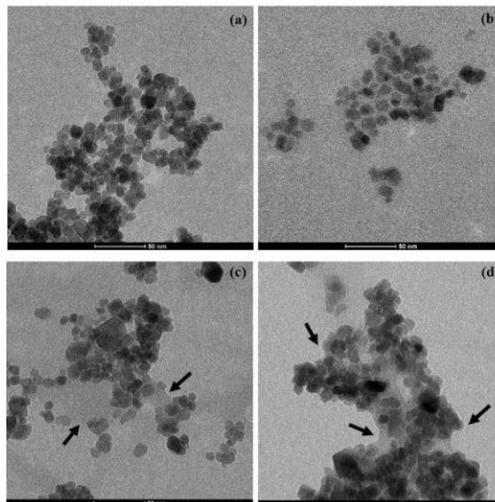
**Figure 1.** TEM images of (a) Fe<sub>3</sub>O<sub>4</sub> (b) Fe<sub>3</sub>O<sub>4</sub>-OA (c) Fe<sub>3</sub>O<sub>4</sub>-OA-CS and (d) Fe<sub>3</sub>O<sub>4</sub>-OA-GCS nanoparticles
