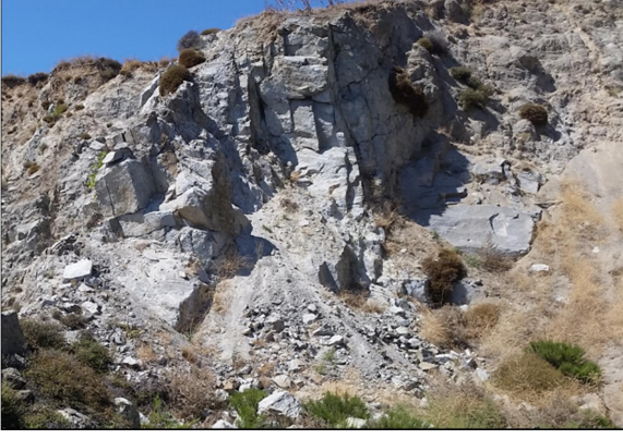
Foto 2: Schmidt çekici Geri Tepme değeri R: 40-50 aralığında olan ölçümlerin yapıldığı, Tablo 1 de sertlik derecesi 3 (orta) olarak tanımlanan granit kaya yüzey örnekleri.
