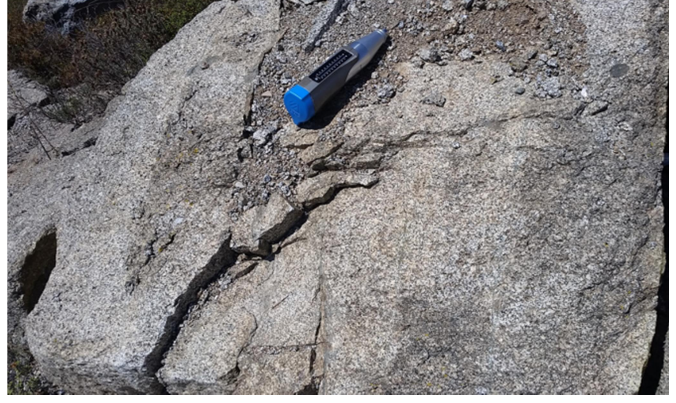
Foto 2: Schmidt çekici Geri Tepme değeri R: 40-50 aralığında olan ölçümlerin yapıldığı, Tablo 1 de sertlik derecesi 3 (orta) olarak tanımlanan granit kaya yüzey örnekleri.
