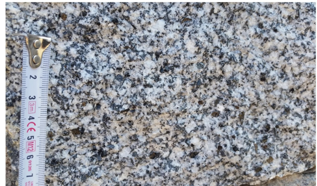
Foto 1: Schmidt çekici Geri Tepme değeri R= 50 - 60 aralığında olan ölçümlerin yapıldığı, Tablo 1 de sertlik derecesi 2 (sert) olarak tanımlanan granit kaya yüzey örnekleri.
