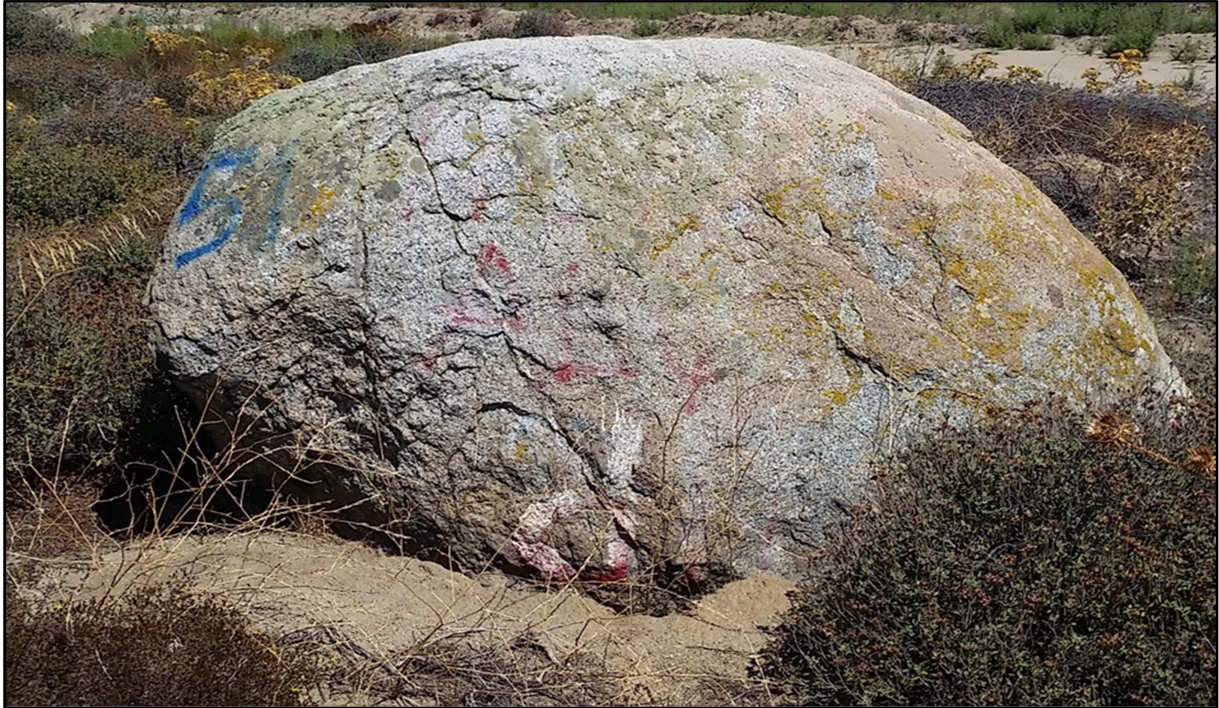
Foto 4: Bu fotodaki örnekte de olduğu gibi eksfoliasyon gözlemlenen granit yüzeylerde; geri tepme değeri düşük, A, S, P değerleri ise yüksek çıkmıştır.
