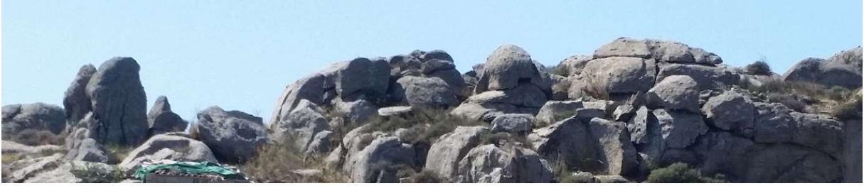
Foto 2: Schmidt çekici Geri Tepme değeri R: 40-50 aralığında olan ölçümlerin yapıldığı, Tablo 1 de sertlik derecesi 3 (orta) olarak tanımlanan granit kaya yüzey örnekleri.
