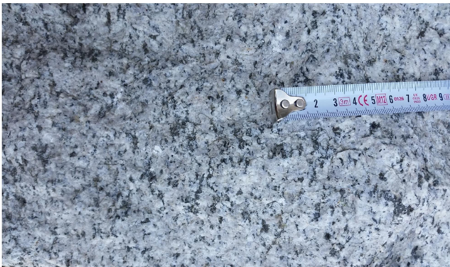
Foto 1: Schmidt çekici Geri Tepme değeri R= 50 - 60 aralığında olan ölçümlerin yapıldığı, Tablo 1 de sertlik derecesi 2 (sert) olarak tanımlanan granit kaya yüzey örnekleri.
