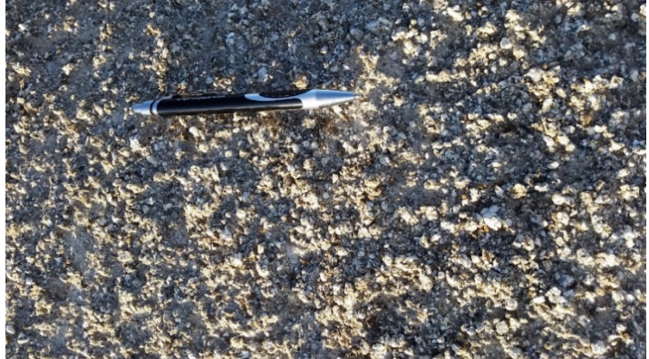
Foto 7: Geri tepme deęeri R: 17-25 aralıęında olan ölçümlerin yapıldığı, Tablo 1 de sertlik derecesi 5 (çok zayıf) olarak tanımlanan grubun alt sınır örneklerine ait dik yamaç granit kaya yüzeyleri. Geri tepme deęeri R: 17-25 aralıęında olan dik yamaçlarda ayrışma çok ileri düzeyde gelişmiştir. Yamaç eteklerinde ve eğim kırığı bölümlerinde farklı tane boyutlardaki döküntüler şeklinde granit kırıntıları ve arena oluşumları çok yaygındır.
