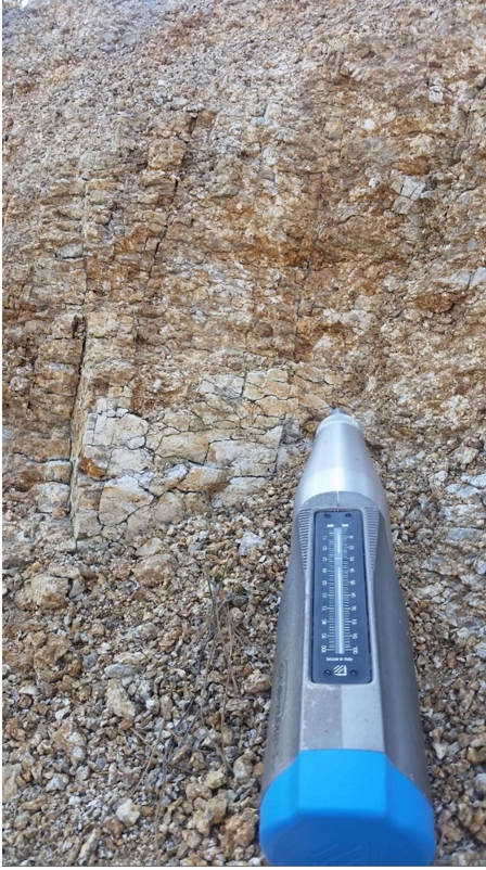
Foto 7: Geri tepme deęeri R: 17-25 aralıęında olan ölçümlerin yapıldığı, Tablo 1 de sertlik derecesi 5 (çok zayıf) olarak tanımlanan grubun alt sınır örneklerine ait dik yamaç granit kaya yüzeyleri. Geri tepme deęeri R: 17-25 aralıęında olan dik yamaçlarda ayrışma çok ileri düzeyde gelişmiştir. Yamaç eteklerinde ve eğim kırığı bölümlerinde farklı tane boyutlardaki döküntüler şeklinde granit kırıntıları ve arena oluşumları çok yaygındır.
