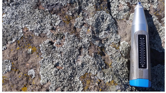
Foto 5: Likenli granit yüzeylerde R_o = 32,00-33,63 arası çıkması; bu durumdaki kaya yüzeylerinin aşınma karşı direncin "Zayıf-Çok Zayıf" sınırına işaret etmektedir.
