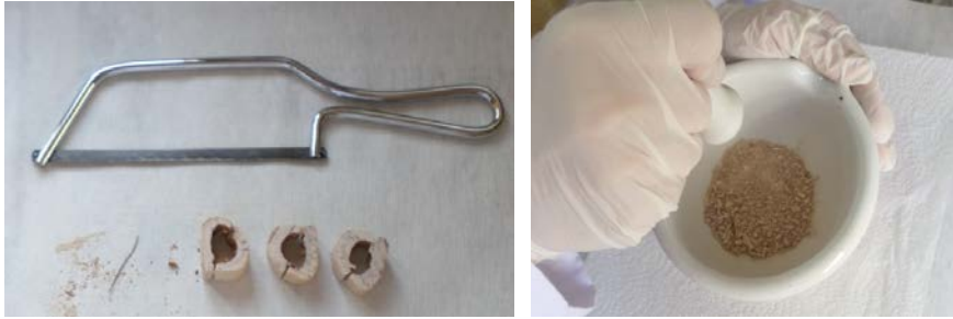
Resim 3. Laboratuvarımızda yapılan çalışmalardan kemik örneklerinden kesit alınması ve pulverizasyon işlemi
